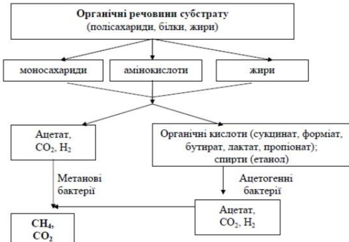
Рисунок 1.1 – Схема поетапного ланцюгового процесу утворення біогазу з органічної біомаси
