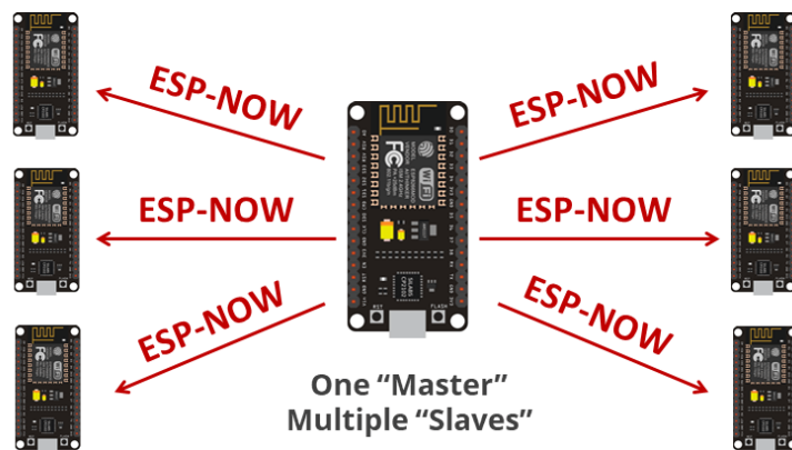
Рисунок 5.2 – Один хаб та багато керованих пристроїв
