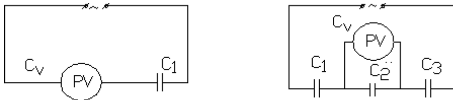
Рисунок 4.6 – Схема електрична принципова приєднання електростатичного вольтметра
